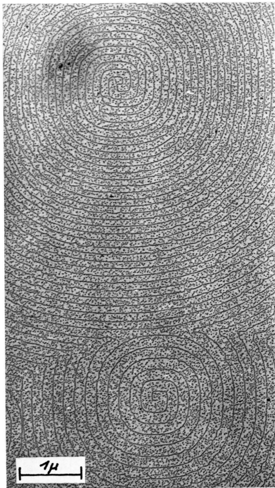
Abb. 1. Abdampfstrukturen im Bereich einer größeren Spaltstufe. Bedingungen: 500 °C, 30 min. Vergr.: 23 000-fach.
